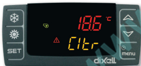
Каждая авария имеет специальный значок (Пр. C1tr: авария термозащиты компрессора 1)
